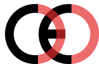
Marcatura CE contraffatta (troppo vicino)
